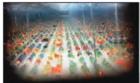
光の反射現象を知る実験 【2枚の鏡による累次反射の着色ブロック像】
